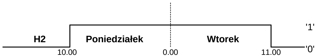
Rys. 4.9.8. Działanie Zegara 2 dla konfiguracji przedstawionej na rys. 4.9.8.
